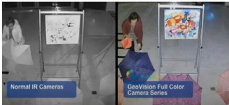
Dank der integrierten LEDs kann die Kamera nachts Farbbilder liefern, die eine bessere Identifikation ermöglichen.
